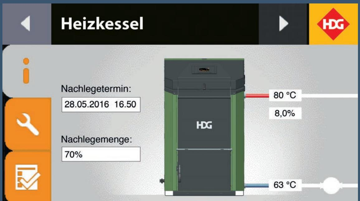
Das große HDG Control Touch XL Display bietet neben einer verbesserten Lesbarkeit einen integrierten Web-Server. Dies ermöglicht auch von unterwegs vollen Zugriff auf die Heizanlage.
